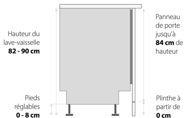
Les charnières coulissantes supportent des panneaux de porte de différents matériaux, pesant entre 3 kg et 10 kg, avec une épaisseur de 16 mm à 25 mm.
