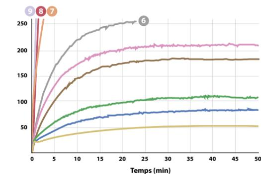
Grâce à la **régulation de** la chaleur, la taque de cuisson ajuste la puissance délivrée à la casserole en fonction de la température réglée et la maintient stable. Cela garantit un contrôle précis de la température et permet d'obtenir des résultats constants et une grande précision, d'une fois sur l'autre.
